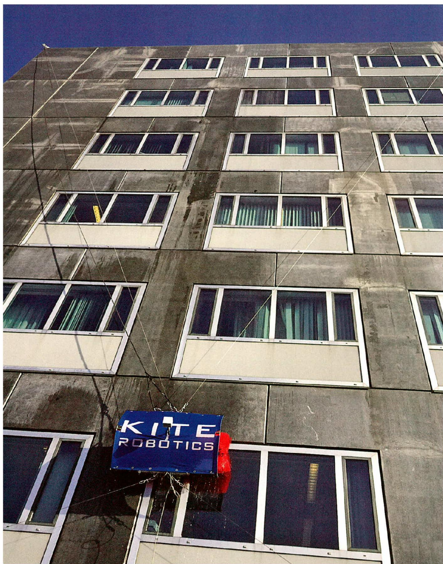
Met zo'n 20 mm per seconde snelt de robot de gevel op en af. Sneller kan eventueel ook.
