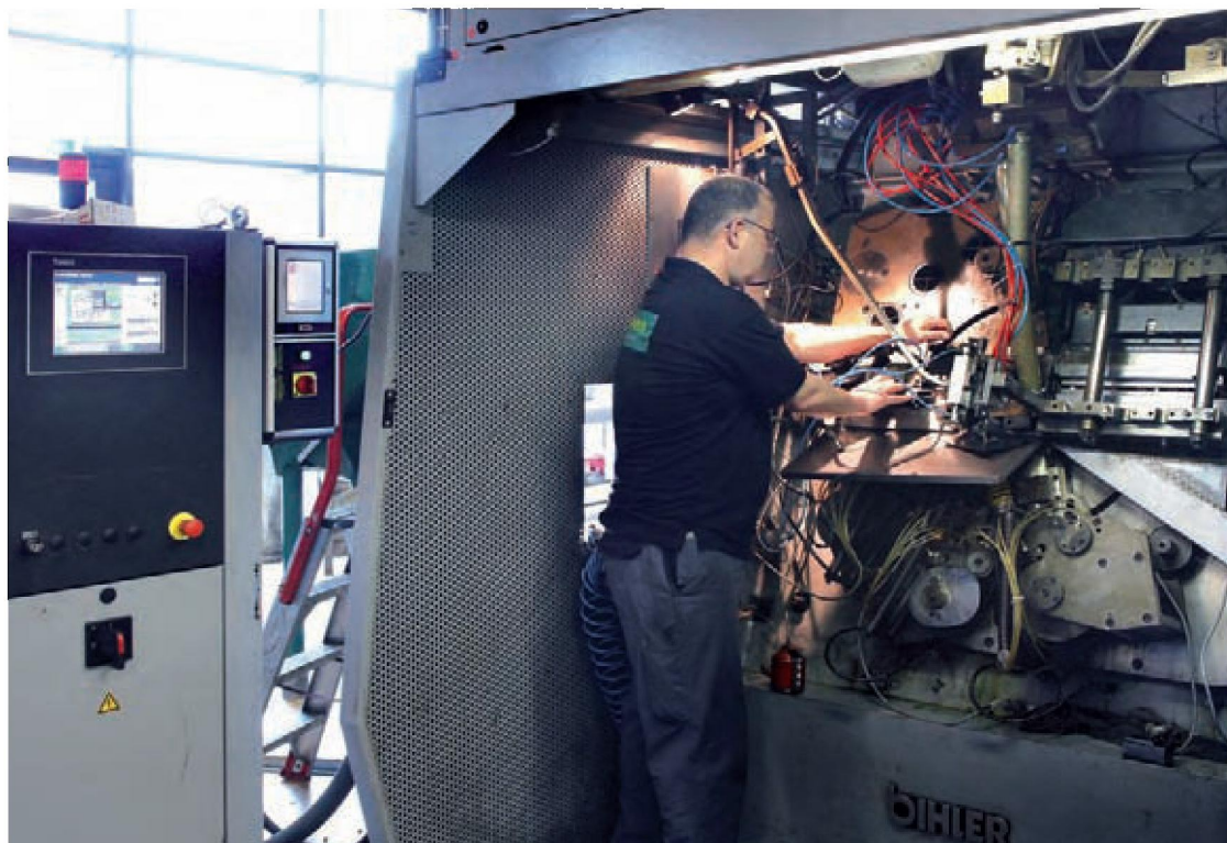
Intuïtie en vakmanschap zijn belangrijke pijlers bij familiebedrijf Walraven. Op de foto maakt een medewerker een stempel voor een bevestigingsbeugel.
